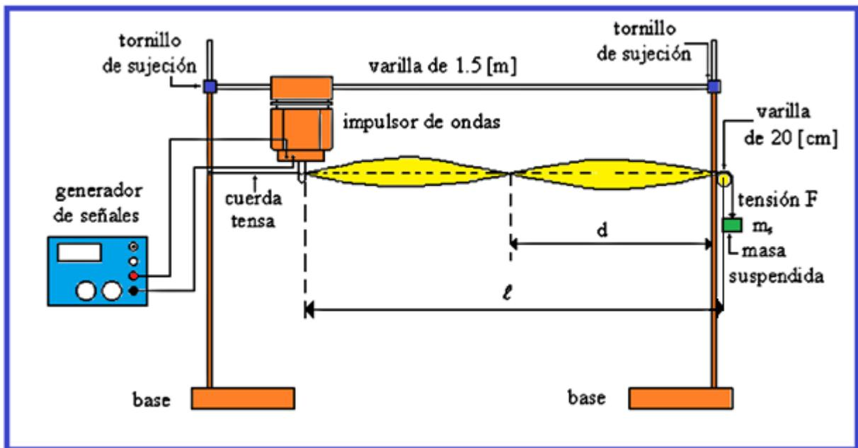
Figura 1. Dispositivo experimental.
