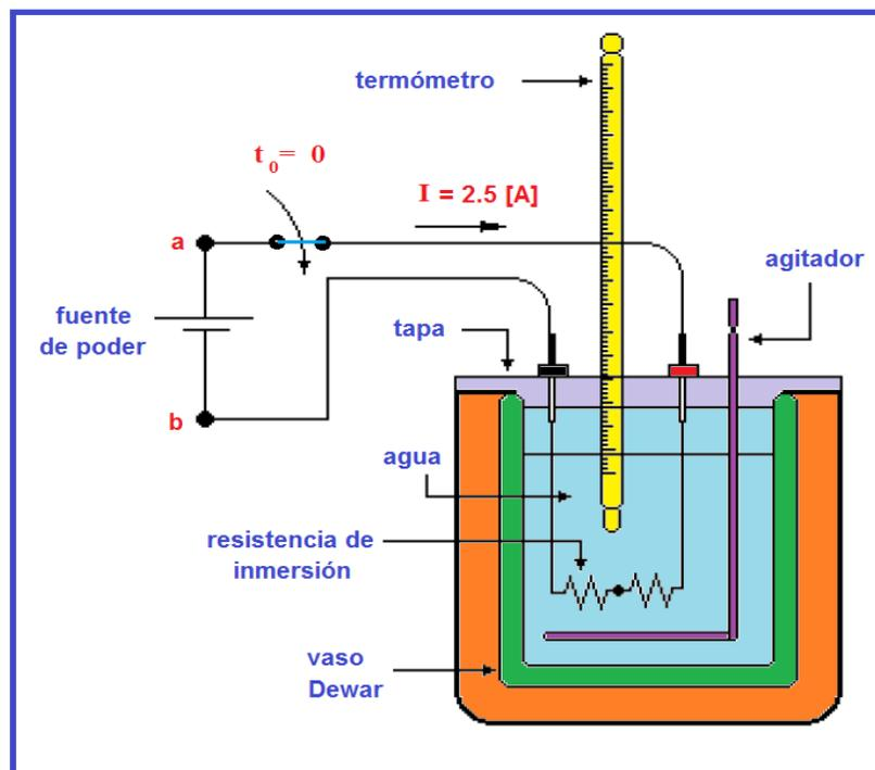
Figura 1. Dispositivo experimental.
