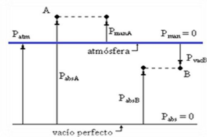
Figura 2. Presión manométrica, presión vacuométrica y presión absoluta.
