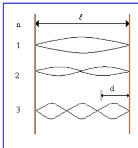
Figura 2. Modos de vibración (n) de ondas estacionarias.
