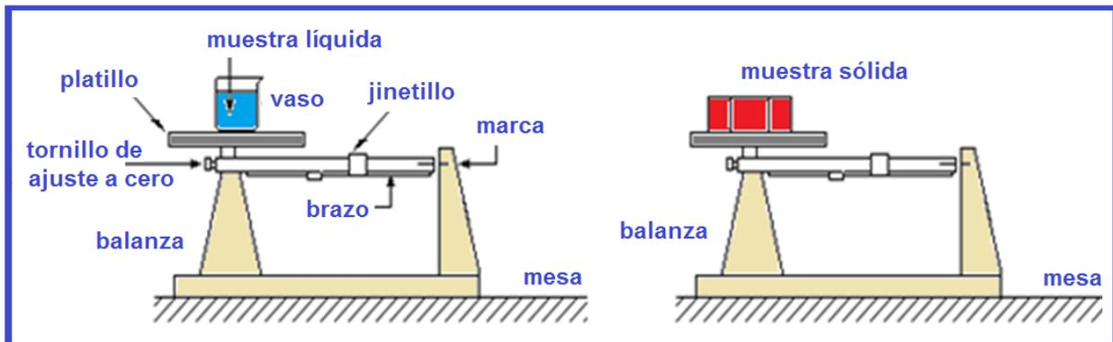
Figura 1. Diagrama de medición de muestras sólidas y líquidas.
